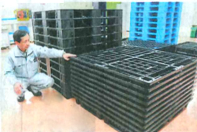
収納に便利なパレットの新製品(手前)。従来のパレット(左奥)と同じ枚数を積み重ねても高さは半分ほどで済む
